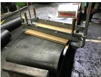
Kaltverbindung mit einer Fixiervorrichtung
