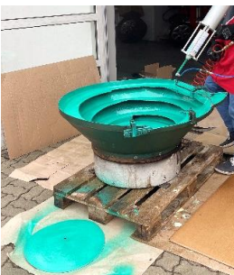
Beschichtung eines Schwingförderers
