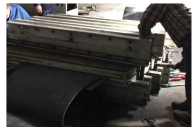
Heißvulkanisieren mit einer hydraulischen Presse
