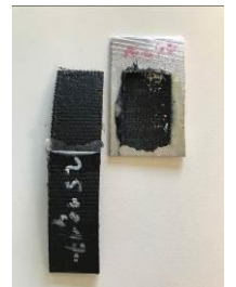
Trommel nach 5 Millionen Umdrehungen (Keine Beschädigung, keine Delaminierung)
