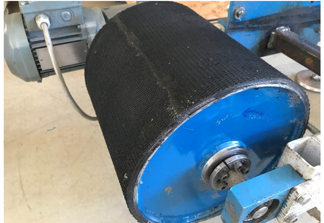
Trommel nach 5 Millionen Umdrehungen (Keine Beschädigung, keine Delaminierung)
