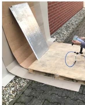
Pneumatisches Sprühen mit 4 Bar und 100 L/min. (400 L/min wird empfohlen)
