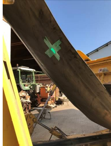
Versiegeln der Rückseite mit Klebeband
