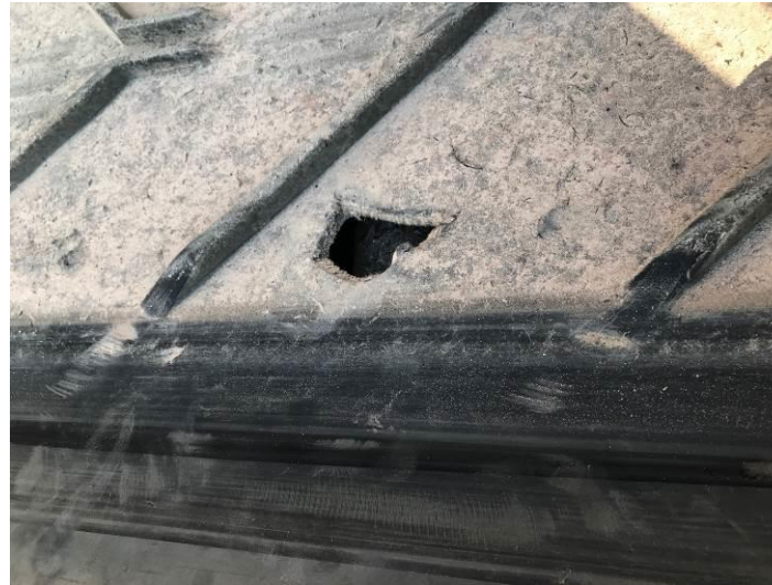
Typisches Loch durch Einschlag von Metall
