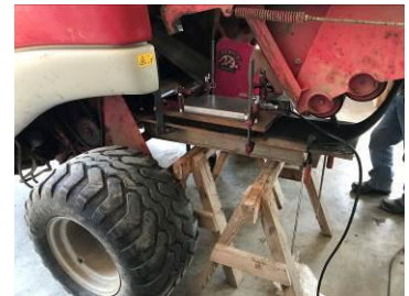
Vulkanisieren mit Fixiervorrichtung und Heizplatte
