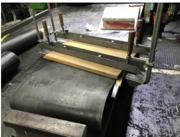
Vulkanisieren bei +20°C mit einer Fixiervorrichtung
