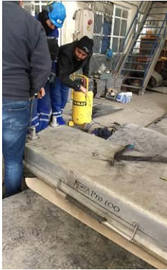
Vulkanisieren mit einer Airbag-Press
