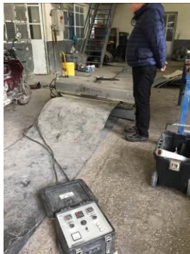
Flächendruck 3.5 bar, Temperatur 80°C und 30 Min. Vulkanisiert
