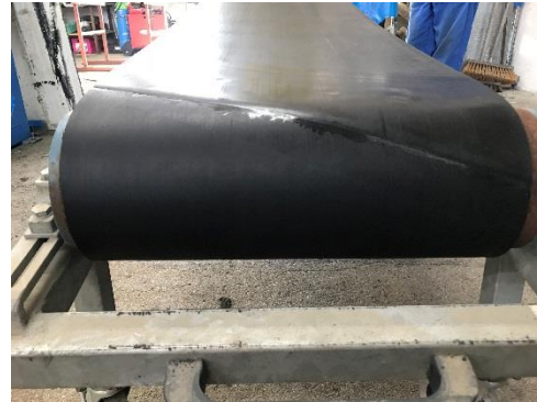
Heißvulkanisierte Verbindung mit Multiface, startbereit 45 Minuten nach dem Schließen der Presse
