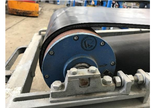
Heißvulkanisierte Verbindung mit Multiface, startbereit 45 Minuten nach dem Schließen der Presse
