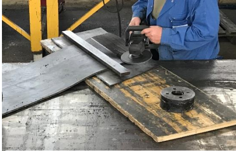
Abschleifen der Stufen
