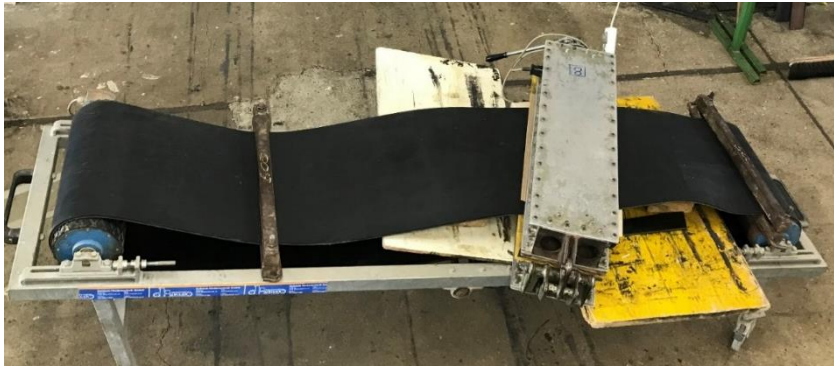
Verpressen mit 2 bar bei 80°C während 30 Minuten inklusive Temperaturanstieg
