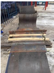
Fingerverbindung von einlagigen Bändern
