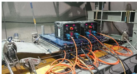
Verbindung von Stahlseilgurten mit einer Vulkanisierpresse
