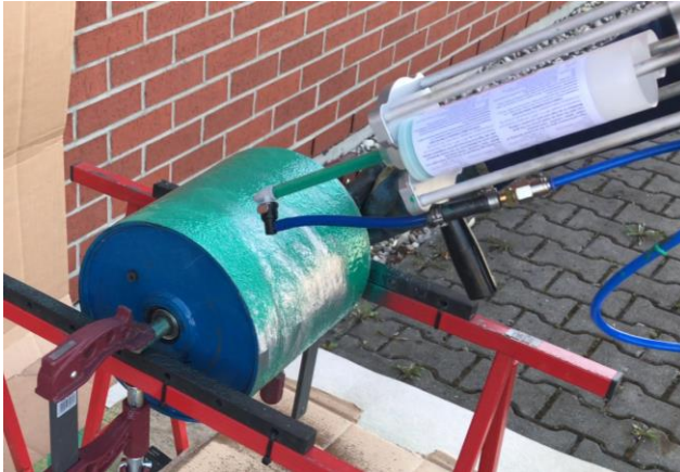
Multi-EP mit einer Sprühpistole oder mit einem Pinsel oder einem Spachtel auftragen und verteilen
