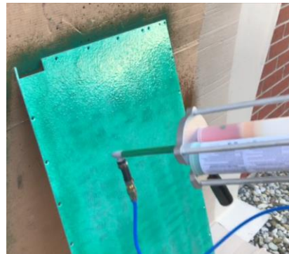
Auftragen mit einer pneumatischen Sprühpistole oder Airless-Sprühpistole
