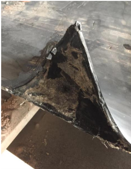
Beschädigte Kante der Stufenverbindung
