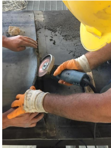
Anrauen der beschädigten Oberfläche
