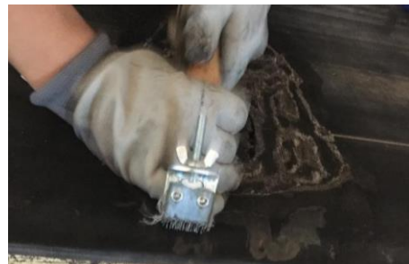
Abschleifen und Anrauen der Oberfläche
