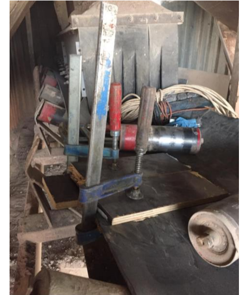
Aushärtung unter einer Fixiervorrichtung
