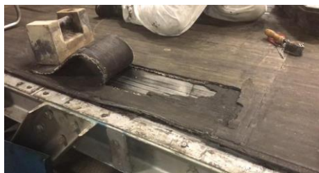
Beschädigte Kante der Stufenverbindung
