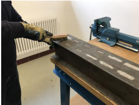
Abtragen von losen Rost mit einer Metallbürste oder einer Rundbürste
