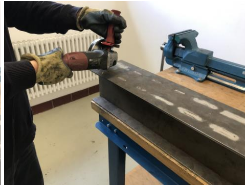
Abtragen von losen Rost mit einer Metallbürste oder einer Rundbürste
