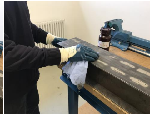
Reinigen der Oberfläche mit Lösungsmittel oder mit einem alkalischen Reiniger
