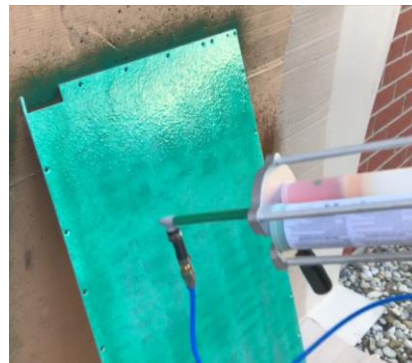
Auftragen mit einer pneumatischen Sprühpistole oder Airless-Sprühpistole
