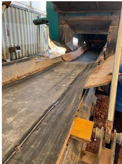
Mobiler Brecher mit 5 m langem Riss
