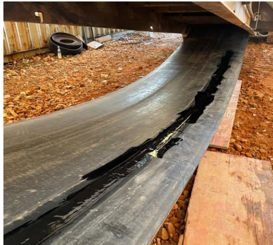
Unterseite ebenfalls abdichten, zum Schluss beide Seiten abschleifen
