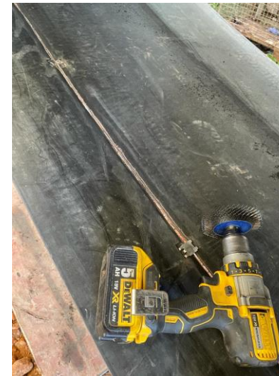
Riss angeraut und mit Sechszack-Verbindern fixiert
