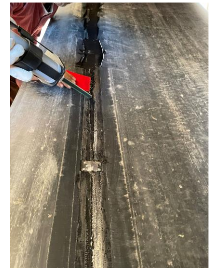
Erste Schicht Multiface 1.5 auftragen
