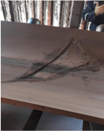
Beschädigte Verbindung des Stahlseilgurtes ST2000
